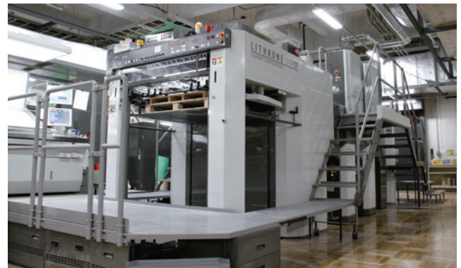
▲東京リスマチックから日経印刷へと移設される四六全判2色/2色両面機（写真は日経印刷株式会社既設の同型機）
